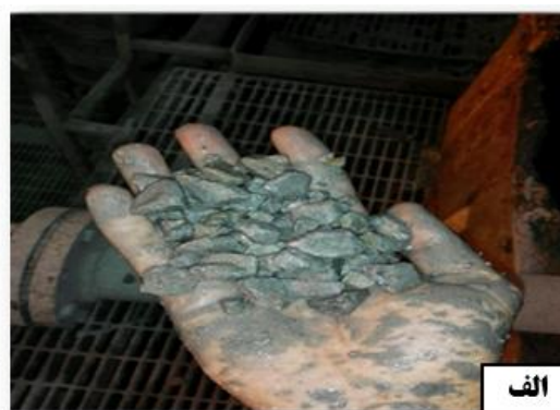
شکل ۵: وضعیت دور ریز سرنده الف- قبل از نصب دوش شستشو ب- بعد از نصب دوش شستشو
