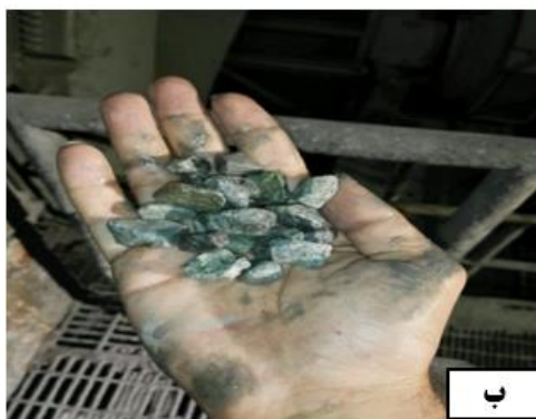
شکل ۵: وضعیت دور ریز سرنده الف- قبل از نصب دوش شستشو ب- بعد از نصب دوش شستشو
